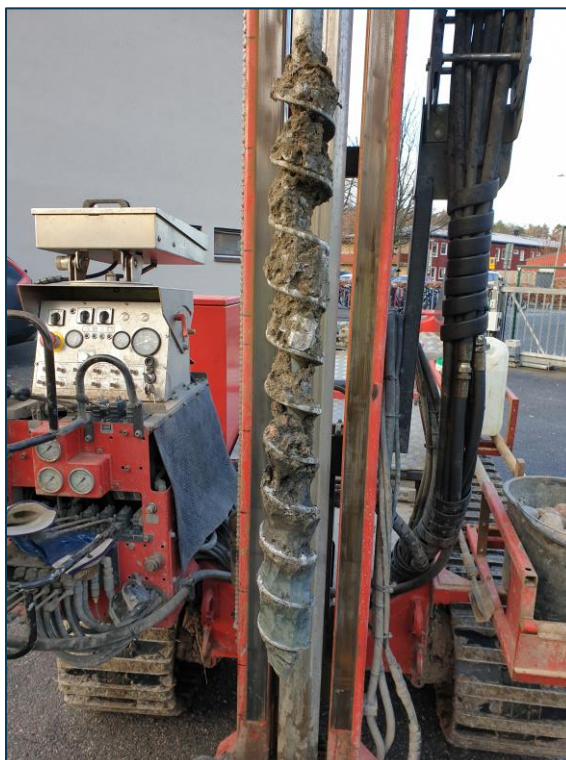
Figur 8. Skruv 1919, sandiga fyllnadsmassor under asfalt på naturlig lera. Ingen indikation på förorening.
